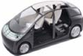
Concept car Toyota 1/X à coque en fibre de carbone
